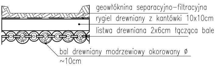
DETAL1a: ŚCIANA A Z BALI DREWNIANYCH W TUNELU 1:20
