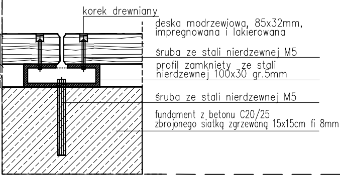
DETAL A2. KONSTRUKCJA I MONTAŻ SIEDZISKA 1:5
